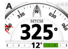
Quando l'operatore cambia rotta, la freccia rossa si sposta ed indica la nuova direzione to go
